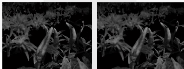
Gambar 3.4 Perbandingan antara citra masukan dan gambar yang difilter Gaussian
