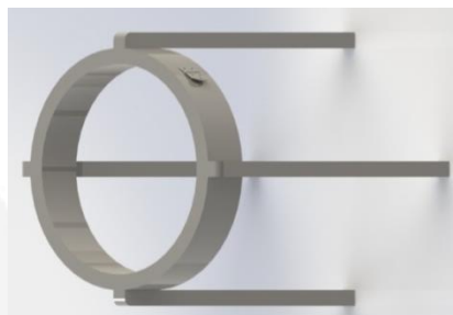
Gambar 3.5 Alat Bantu Pemasangan Pass Roll
