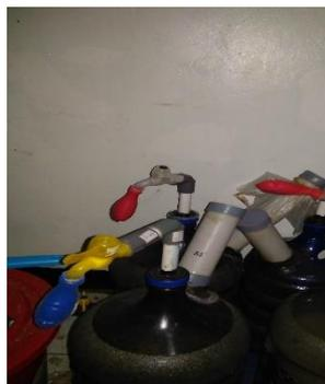
Gambar 2.1 Reaktor anaerob.
