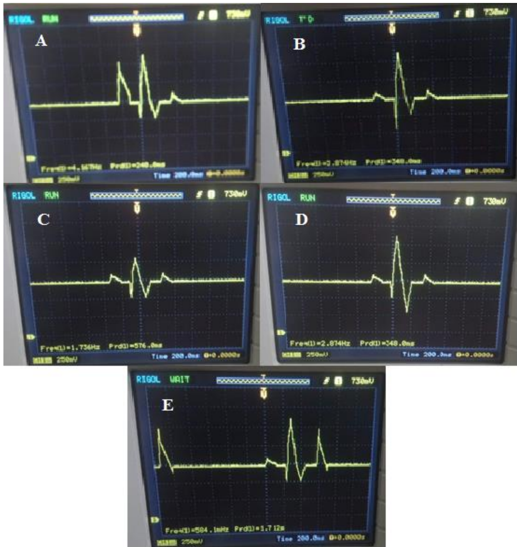
Gambar 4.13 Percobaan perubahan parameter amplitudo P menjadi 500 mV (a) Percobaan perubahan parameter amplitudo Q menjadi -500 mV (b) Percobaan perubahan parameter amplitudo R menjadi 250 mV (c) Percobaan perubahan parameter amplitudo S menjadi -500 mV (d) Percobaan perubahan parameter amplitudo T menjadi 500 mV (e) Dalam gambar ini menunjukkan skala 250mV dan 1 s per kotak nya.
