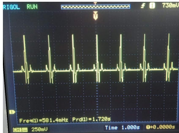
Gambar 4.8 Hasil keluaran simulasi sinyal ECG di osiloskop. Dalam gambar ini menunjukkann skala 250mV dan 1 s per kotak nya
