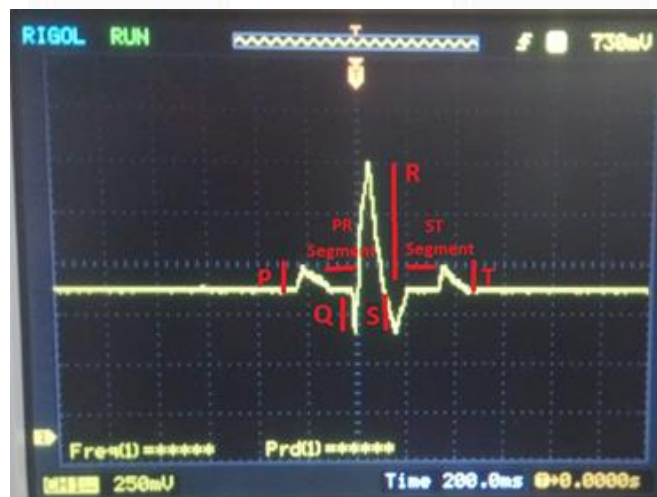
Gambar 4.10 Gambar karakteristik sinyal simulasi sinyal ECG Dalam gambar ini menunjukkann skala 250mV per kotak nya.
