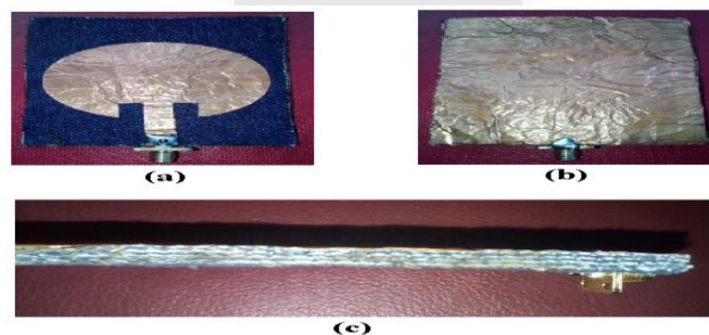
Gambar 5 Hasil Pabrikan Antena Tampak Depan (a), Belakang (b) dan Samping (c)
