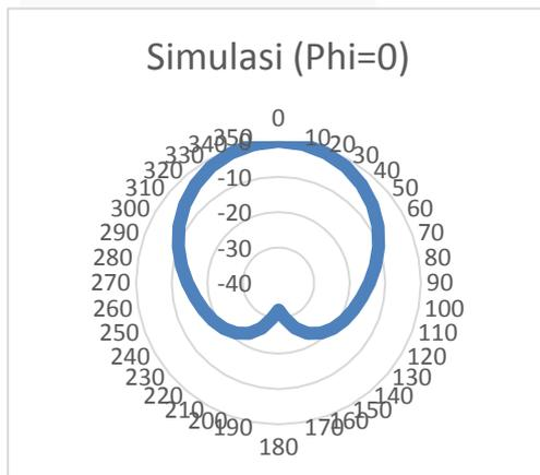
Gambar 4.4 Hasil Simulasi Pola Radiasi Bentuk Polar Kondisi Biasa
