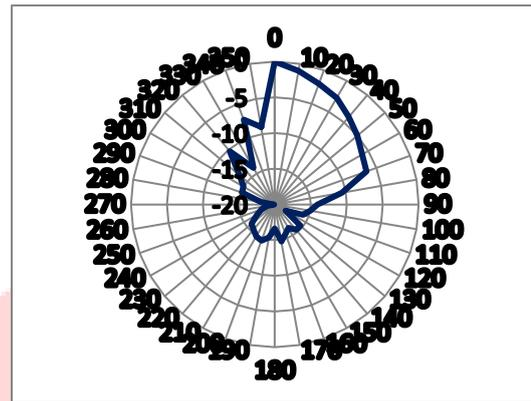
Gambar 4.7 Hasil Pengukuran Pola Radiasi Kondisi *On Body*
