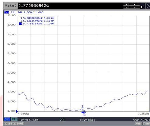
Gambar 4.3 Pengukuran VSWR Kondisi On Body
