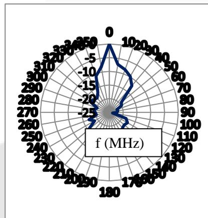
Gambar 4.5 Hasil Pengukuran Pola Radiasi Kondisi Biasa
