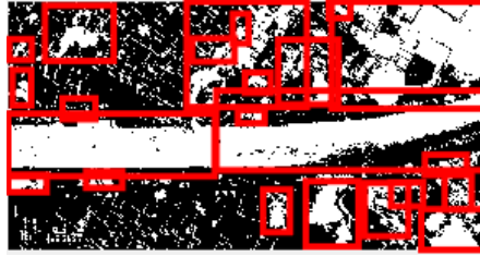
Gambar 10. deteksi kontur awal dengan filter luas 500
