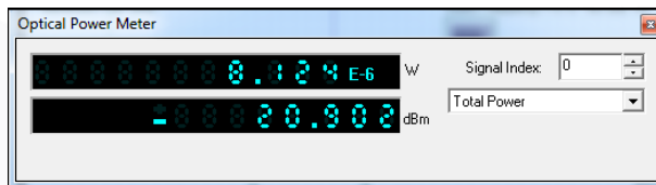
Gambar 4.4 Link Power Budget simulasi jarak transmisi 20 km pada Optical Power Meter
