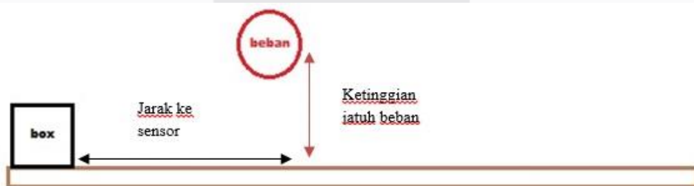
Gambar 4-1. Skema pengujian sensor dengan jarak dan ketinggian.
