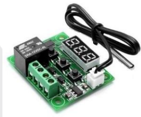
Gambar 2.1 Thermostat dengan Relay
