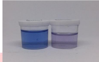
Gambar 3.10 Methylene Blue 15,625 mg/l dengan TiO 2
