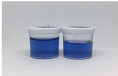
Gambar 3.7 Methylene Blue 31,25 mg/l Tanpa TiO 2
