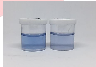
Gambar 3.12 Methylene Blue 7,8125 mg/l dengan TiO 2
