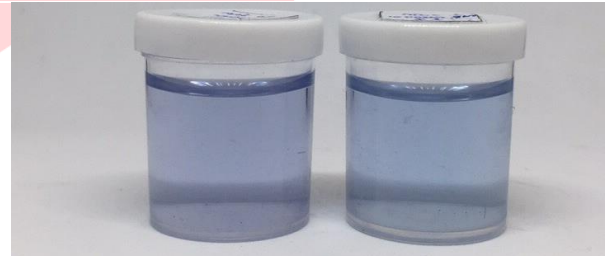
Gambar 4.6 Hasil penyinaran limbah air Methylene blue dengan TiO 2 yang disisipi bubuk karbon sebanyak 0,5g
