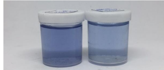
Gambar 4.2 Hasil penyinaran limbah air Methylene blue dengan TiO 2 yang disisipi bubuk karbon sebanyak 0,1g
