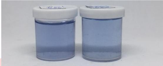
**Gambar 4.4** Hasil penyinaran limbah air Methylene blue dengan TiO<sub>2</sub> yang disisipi bubuk karbon sebanyak 0,3g
