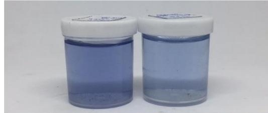
**Gambar 4.2** Hasil penyinaran limbah air Methylene blue dengan TiO<sub>2</sub> yang disisipi bubuk karbon sebanyak 0,1g
