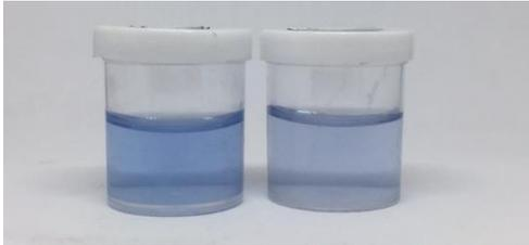
**Gambar 4.1** Hasil penyinaran limbah air Methylene blue dengan TiO<sub>2</sub> murni tanpa sisipan bubuk karbon
