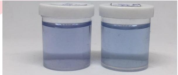
**Gambar 4.6** Hasil penyinaran limbah air Methylene blue dengan TiO<sub>2</sub> yang disisipi bubuk karbon sebanyak 0,5g
