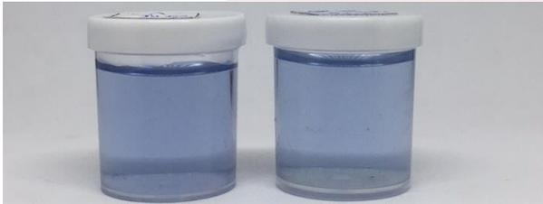
**Gambar 4.5** Hasil penyinaran limbah air Methylene blue dengan TiO<sub>2</sub> yang disisipi bubuk karbon sebanyak 0,4g
