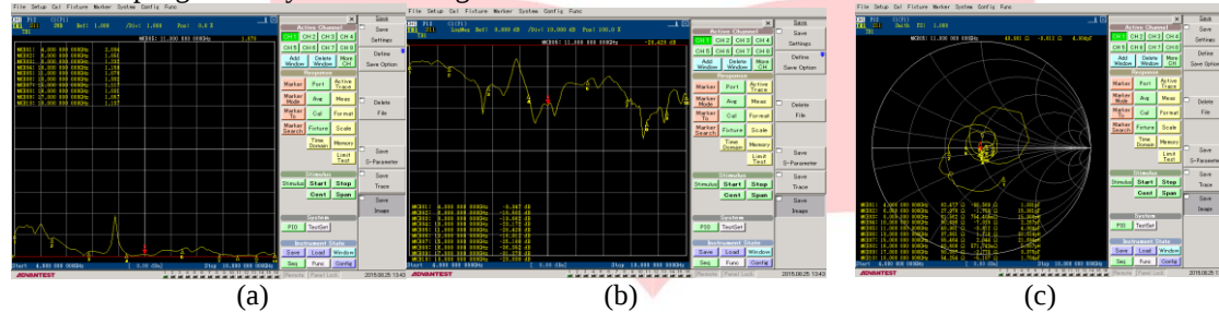
Gambar 7 Grafik Pengukuran (a) VSWR , (b) Return Loss , (c) Impedansi
