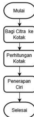
Gambar 4 Diagram Alir Proses Ekstraksi Ciri
