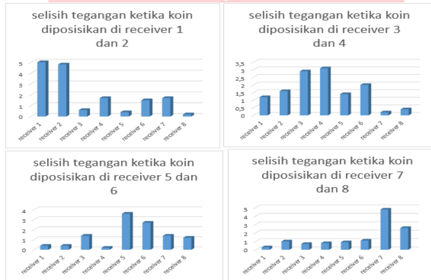
Gambar 5 Grafik identifikasi koin dengan konfigurasi koil berdiameter 3,3 cm
