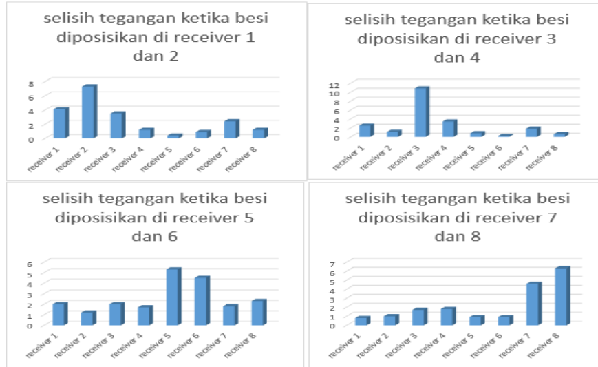
Gambar 6 Grafik identifikasi besi dengan konfigurasi koil berdiameter 2,2 cm
