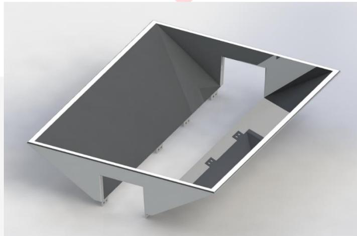
Gambar 7 Perancangan Corong *Conveyor* Mesin PCR
