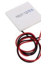
Gambar 2.1 Modul Termoelektrik
