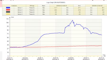
Gambar 4.3 Grafik Suhu Kompor Saat Rentang Suhu 0 – 100<sup>o</sup> Celcius Saat Pengambilan Data dengan Menggunakan Multimeter
