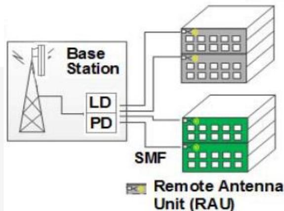
Gambar 1. Sistem Radio over Fiber untuk sel piko
