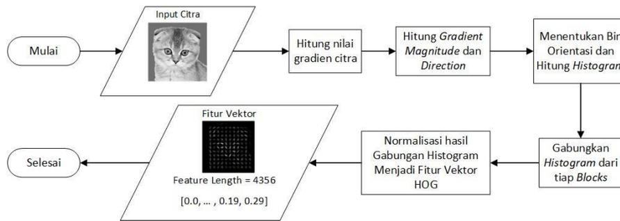
Gambar 7. Ekstraksi Fitur dengan Histogram of Oriented Gradients sistem pengenalan ras kucing
