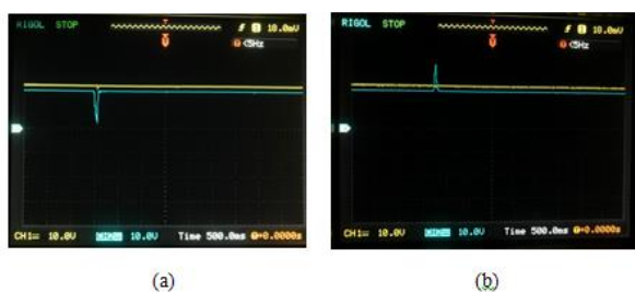
Gambar 4. 15 Hasil Pengukuran Beban di 65 \Omega Menjadi (a) 60 \Omega (b) 70 \Omega (Note : x = 500 ms/div dan y = 5V/div , Sinyal Kuning = Input , Sinyal Biru = Ouput)
