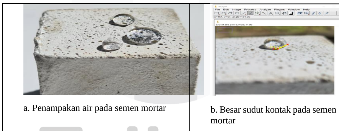
Gambar 6. Semen mortar direndam 10% \text{Ca(OH)}_2 dan tidak dilapisi larutan campuran. sudut kotak rata-rata adalah 154,14 derajat.
