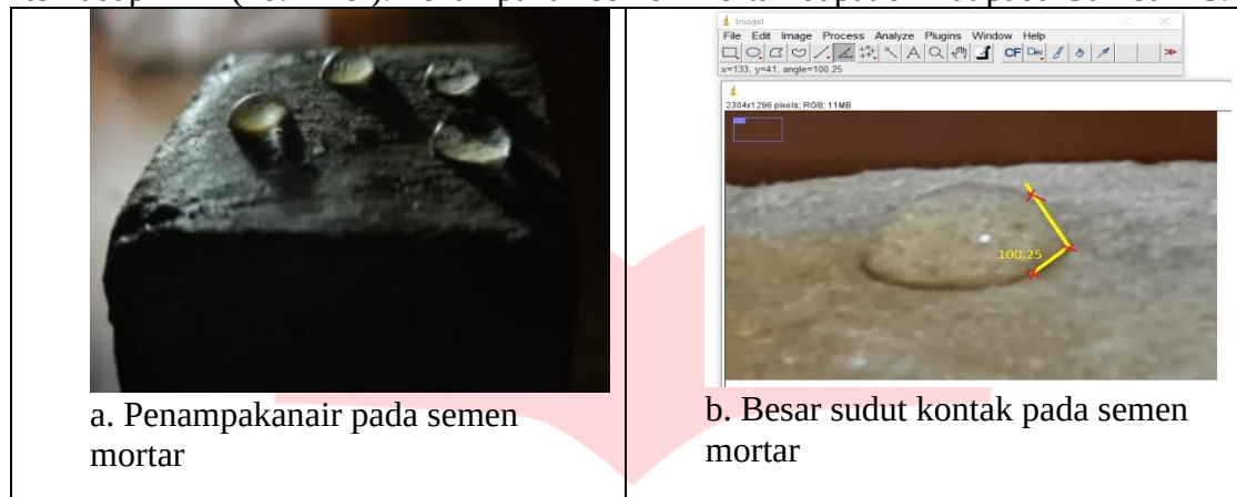
Gambar 13. Semen mortar semen mortar direndam 20% dan dilapisi larutan campuran poliuretan terhadap THF (10:1 mol). sudut kotak rata-rata adalah 100,54 derajat.
