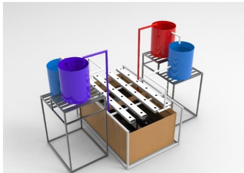
Gambar 2.4 Desain sistem akuaponik
