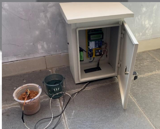
Gambar 5 Peletakan Sensor Suhu dan Kelembaban
