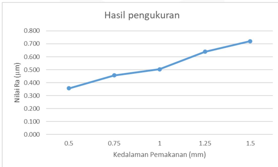
Gambar 7 Grafil Pengukuran Ra untuk Eksperimen Depth of Cut
