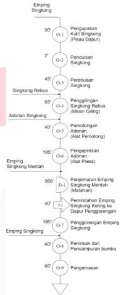
Gambar 1 Alur produksi emping singkong
