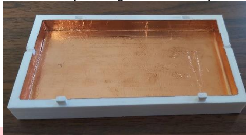
Gambar 3.5 Bagian dalam dari rectangular waveguide setelah dilapisi oleh selotip
