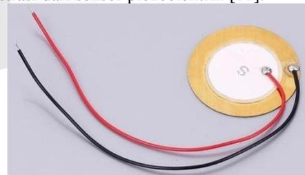
**GAMBAR 2.5** Sensor Piezoelektrik
