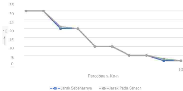
Gambar 4.3 Grafik Kalibrasi Respon Sensor Tanpa Menggunakan Air
