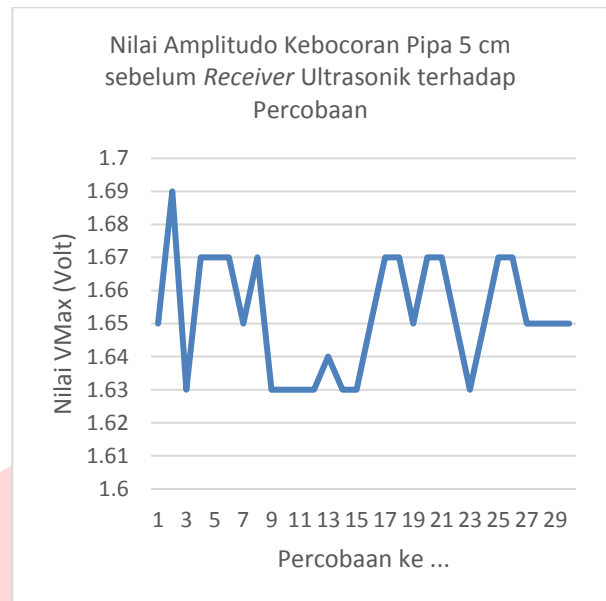
GAMBAR 10 Data nilai Amplitudo kondisi Pipa Bocor 5 cm dari Receiver Ultrasonik
