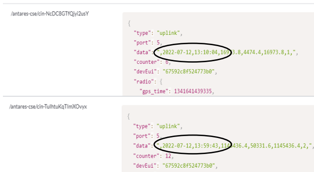
GAMBAR 12 PENGUJIAN RANGKAIAN RTC PADA ANTARES
