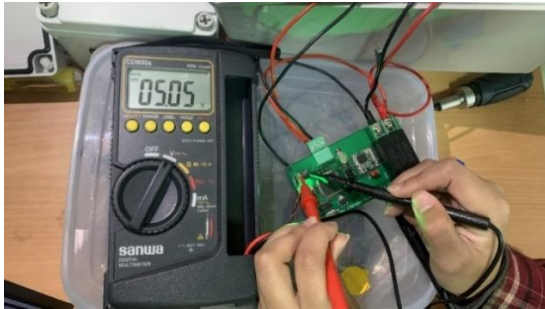
GAMBAR 9 PENGUKURAN TEGANGAN IC MAX485
