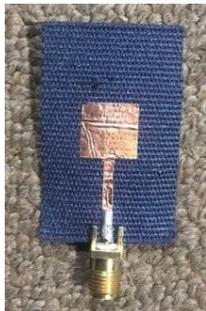
Gambar 4.1 Tampak depan antenna fabrikasi.
