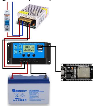
GAMBAR 8 DESAIN RANGKAIAN SISTEM DAYA
