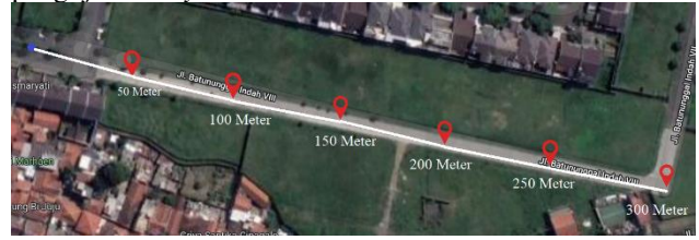
GAMBAR 13 PENGUJIAN JARAK MODUL LORA
