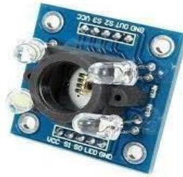
GAMBAR 4 SENSOR WARNA TCS 230.
