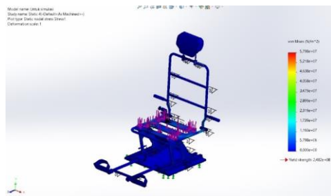
GAMBAR 15 (Stress analysis pada produk usulan)
