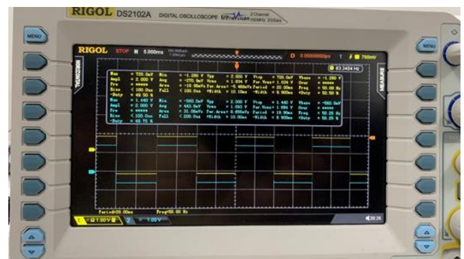
Gambar 10 Hasil PV dan PLN yang sudah sinkron
