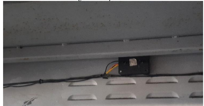
GAMBAR 4.4 Pemasangan Modul Sensor pada Kendaraan
