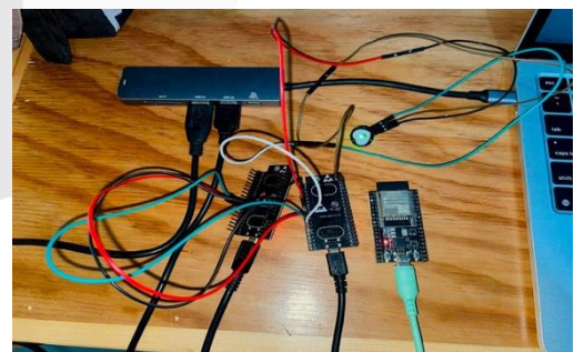
GAMBAR 5 Penyambungan Sensor Pulse Ke ESP 32
