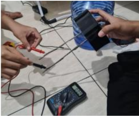
GAMBAR 10. Pengukuran Volt Pada Elektroda (LED Off)
