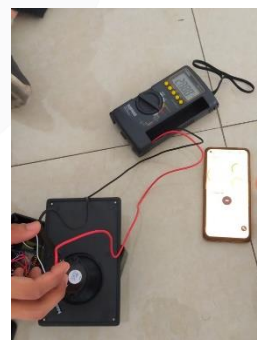
GAMBAR 4 Pengukuran Frekuensi Output dengan Multimeter
