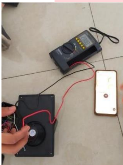
GAMBAR 4 Pengujian frekuensi ultrasonik menggunakan multimeter digital
