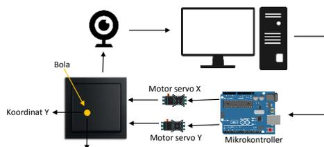
Gambar di atas menunjukkan alur proses kerja keseluruhan. Proses ini menggunakan pemrograman menggunakan PC. Nantinya hasil dari pemrograman tersebut akan diolah dan akan dikirimkan secara serial kedalam mikrokontroler yaitu Arduino. Mikrokontroler Arduino kemudian akan menggerakkan motor servo, dan motor servo akan mengubah kemiringan *Plate* sehingga bola akan bergerak menuju posisi yang diinginkan. Posisi bola akan terus ditangkap oleh kamera untuk
