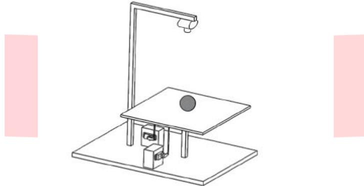
Sistem *Ball on Plate* menggunakan kamera sebagai sensor untuk mengetahui posisi bola yang dibaca oleh kamera akan diolah menggunakan proses pengolahan citra, data atau posisi bola kemudian hasilnya akan diteruskan ke pengendali. Data yang dikirimkan ke dalam pengendali akan diproses dan data tersebut akan menggerakkan motor servo menggunakan metode *fuzzy logic* sehingga posisi bola berada pada titik tengah atau *set point* yang diinginkan.
