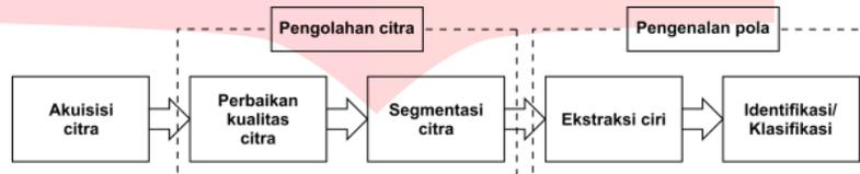
Gambar di atas merupakan proses pengolahan citra. Proses pengolahan citra dimulai dengan mengakuisisi citra menggunakan *webcam* lalu kualitas citra diperbaiki dan citra akan disegmentasi. Segmentasi citra yang digunakan adalah *thresholding* RGB dengan batasan 255 untuk setiap warna. Proses selanjutnya adalah mengekstraksi ciri menjadi warna putih. Setelah itu, bola akan teridentifikasi.
