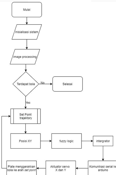
Output dari sistem ini adalah bola akan berada pada *set point* yang berbeda-beda yang telah ditentukan. Koordinat bola diketahui setelah data dari *webcam* diproses oleh metode *image processing* yang selanjutnya data diproses kembali dengan
