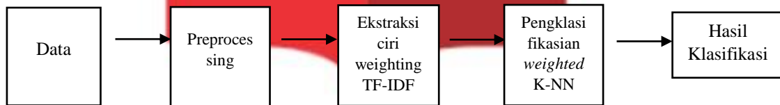
Gambar 3: Rancangan sistem Klasifikasi menggunakan K-NN
