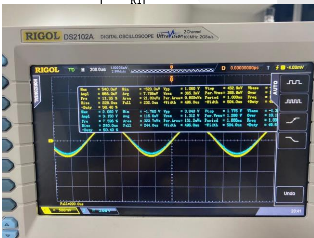
GAMBAR 23 Hasil Keluaran Non - Inverting pada Osiloskop
