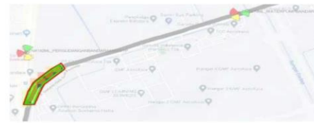
GAMBAR 14 KONDISI COVERAGE SINR SETELAH PERBAIKAN PADA BAD SPOT 1
