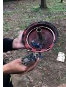
GAMBAR 10. PELETAKKAN MIKROKONTROLLER DAN SENSOR
